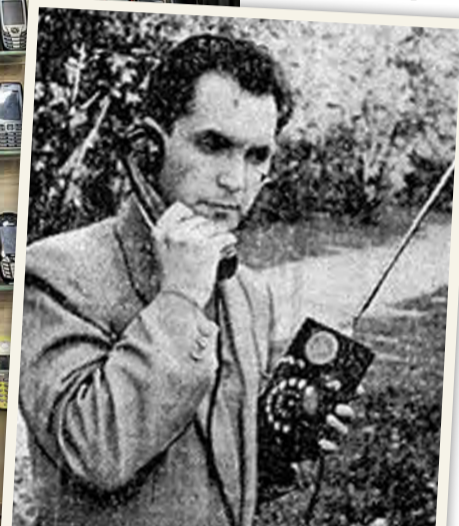
В 1957 году советский инженер Л. Куприянович создал экспериментальный мобильный телефон весом 3 кг и радиусом действия 20–30 км
